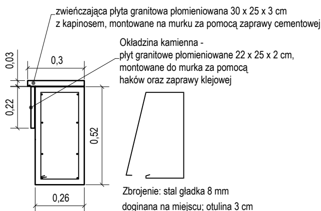
6 Podmurówka/ zbrojony murek oporowy - przekrój 1:20
